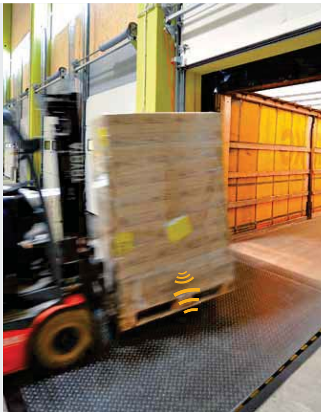
Automatické zachycování pohybů zboží, jednoduše při přejezdění nakládacího můstku.
